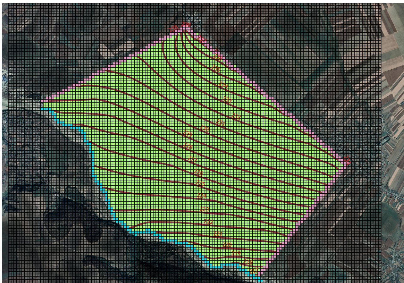
Figura 3 – Harta suprafeței piezometrice rezultată în urma procesului de calibrare
