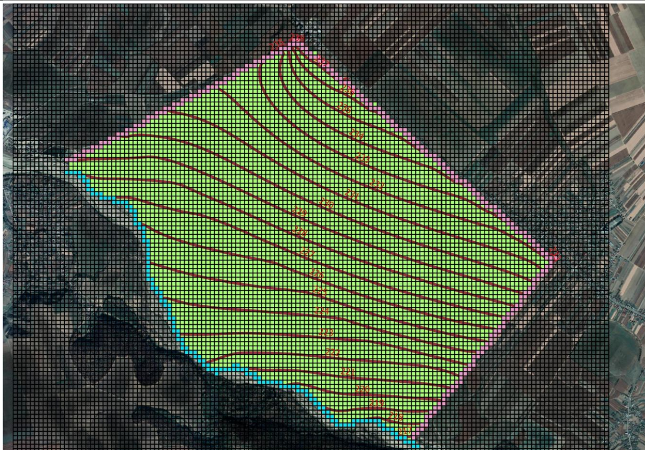
Figura 10: Harta suprafeței piezometrice rezultată în urma procesului de calibrare
