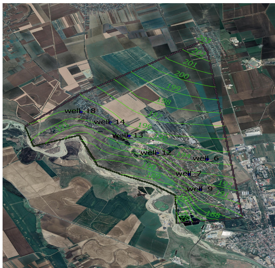
Figura 3 – Harta suprafeței piezometrice rezultată în urma procesului de calibrare
