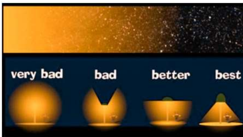
Figura nr. 5-1 Exemplu al unui sistem de iluminare adecvat pentru concentrarea dispersiei exclusiv asupra carosabilului
