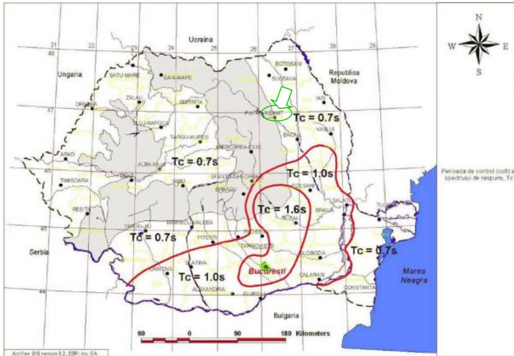
Figura - Zonarea teritoriului României în termeni de perioada de control (colț) T_c a spectrului de răspuns
